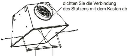
dichten Sie die Verbindung des Stutzens mit dem Kasten ab
