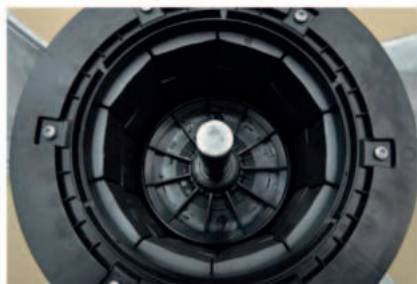
Ocelový rotor s umělohmotným chladičím kolem
