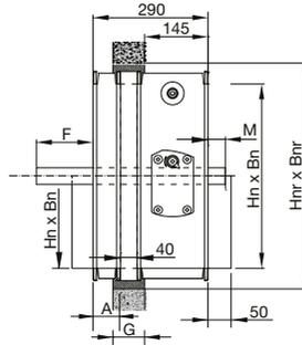
Anschluss an Vierkanrohr, mit Flansch
