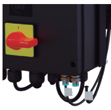
pohled na diferenciální tlakové čidlo s převodníkem a plastové hadičky k odběru statického nebo dynamického tlaku v potrubí a ve volném prostředí
