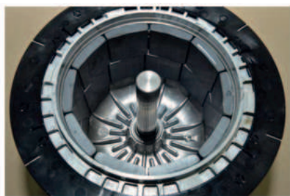
rotor z Al tlakového odlitku s umělohmotnou deskou (není znázorněna) na prstenci
