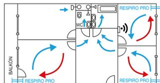
Jednotka je vybavena čidlem relativní vlhkosti. Ventilátor je umístěn za výměníkem, což garantuje minimální hlučnost jednotky.
