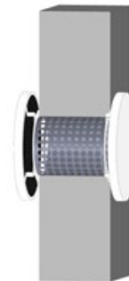
Installation des Ventils in der Wand mit dem perforierten Wandelement VSCZ
