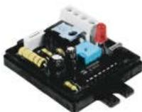
DT 3-PR nach Entfernen der Abdeckung
