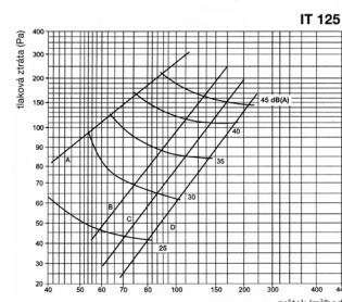
Otevření ventilu: A=1/4, B=1/2, C=3/4, D = 1/1
