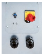
detail bezpečnostního vypínače a potenciometru umožňujícího regulaci otáček
